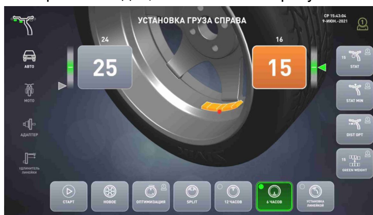
Рисунок 5.8 – Установка в «6 часов» справа
